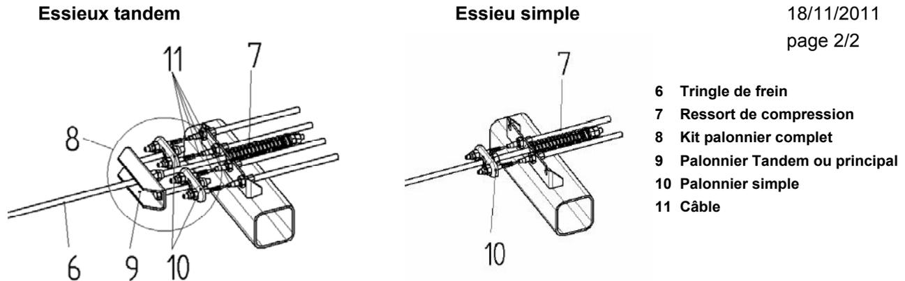
Pré-monter les palonniers [8] avec les écrous sur la tringle [6] et les câbles [11] sans les bloquer ni exercer de tension sur les câbles ; les embouts des câbles devant dépasser de 5 à 8 mm des écrous.
